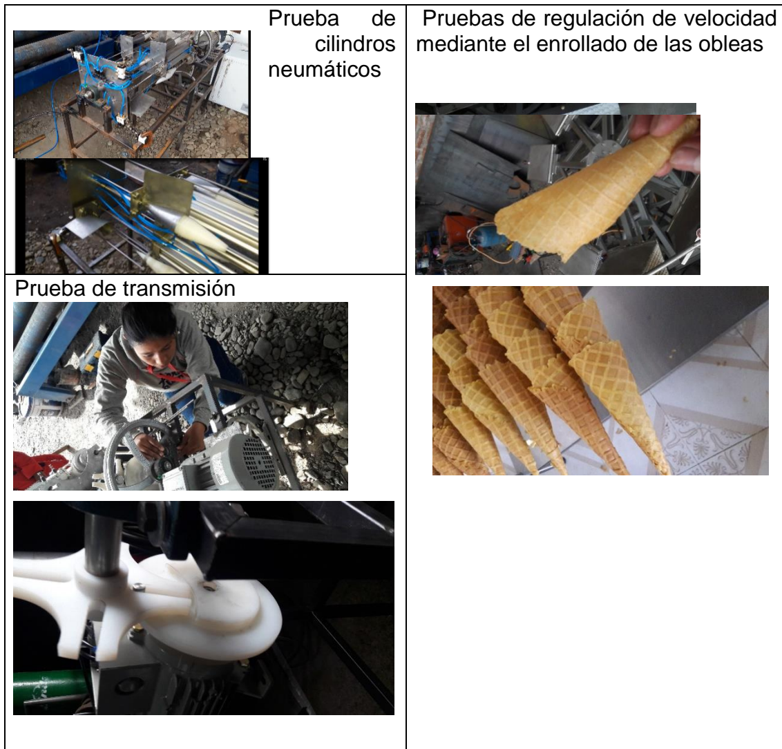
Figura 52: Pruebas de funcionamiento
