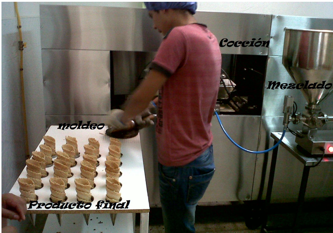
Figura 3: Proceso de elaboración de conos de helados
