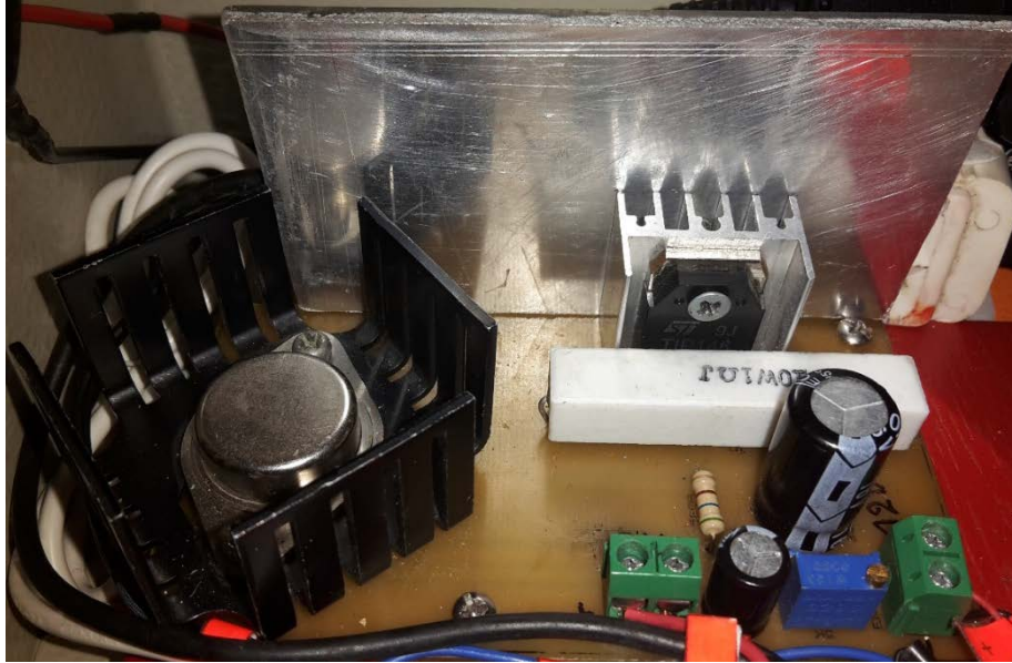
Figura 3.7 Placa de control del efector final de salida 1.2 a 12 V a 10 A
