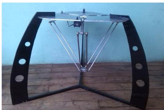
**Figura 7: Esquema del robot Delta**
