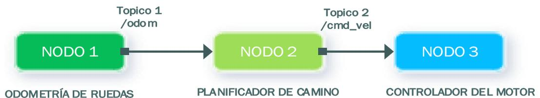
**Figura 9: Esquema de funcionamiento nodos (node) y temas (topics)**
