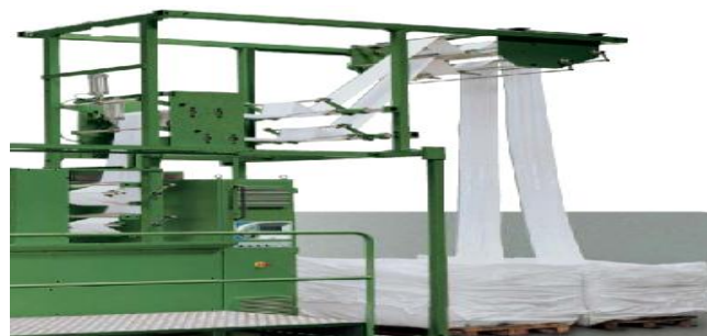
Fig. 21 Fileta Maquina Convertidora.
