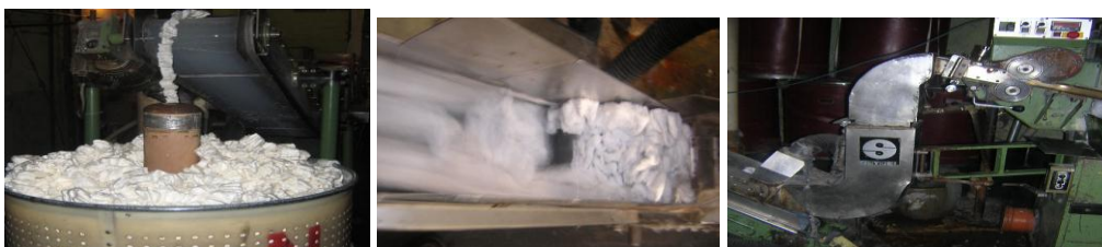
Fig. 16 Caja de vaporizado Termoseccionadora.
