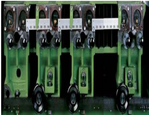
Fig. 31 Reglas de Ecartamientos Zona de corte Rebreker
