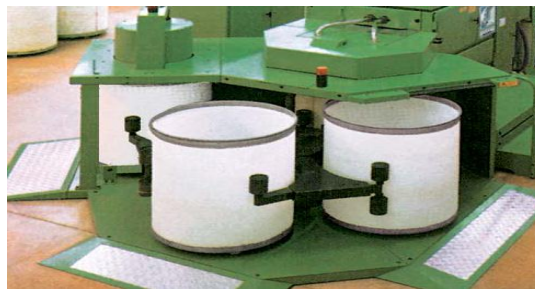
Fig. 30 Sistema de recolección de cinta Rebreker
