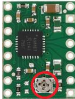
Figura 3.4 Tornillo de ajuste de V_{REF} en el drive A4988, (Pololu, 2001)
