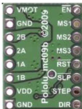
Figura 3.2 Esquema de pines para microstep, (Pololu, 2001)
