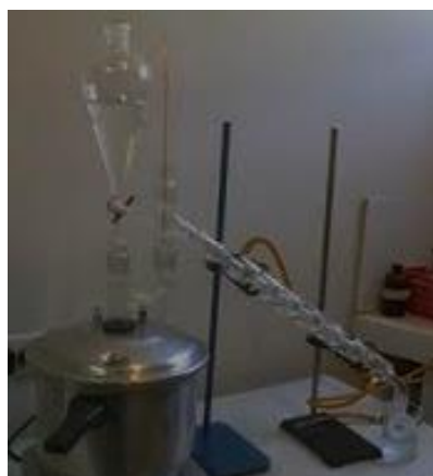
Figura 30: Hidrodestilación de la menta
