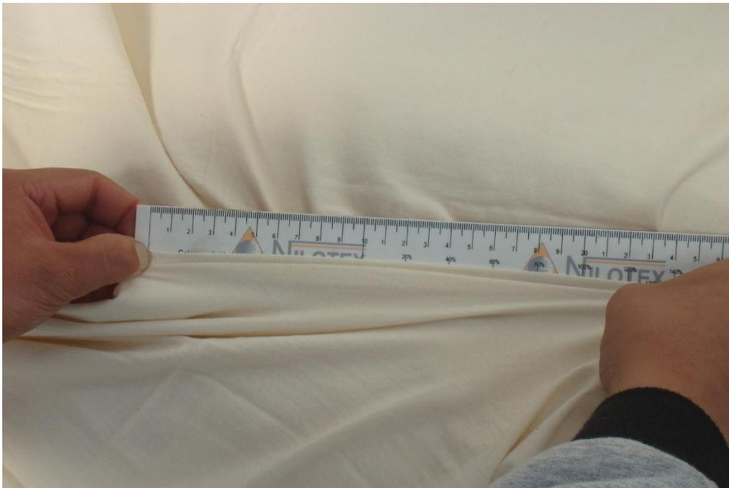
**Figura N° 22. Control de la elasticidad en la tela cruda.**
