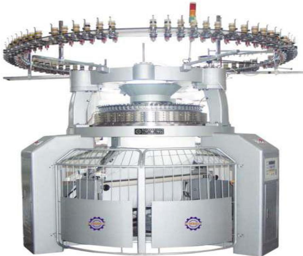
**Figura N° 14. Máquina circular**
