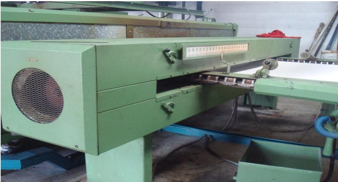
**Figura N° 30. Cámara de enfriamiento.**
