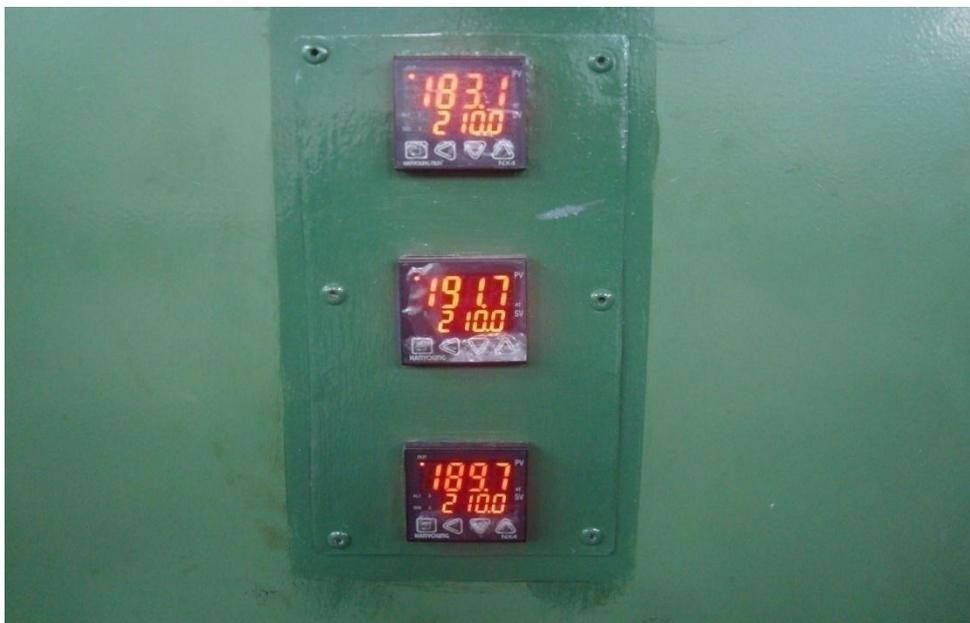
**Figura N° 28. Los controladores de temperatura.**
