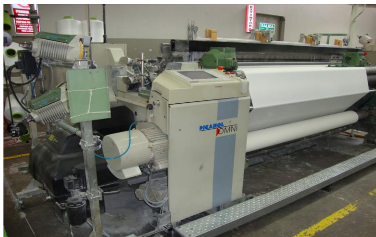
Telar marca Picanol con sistema de inserción por aire
