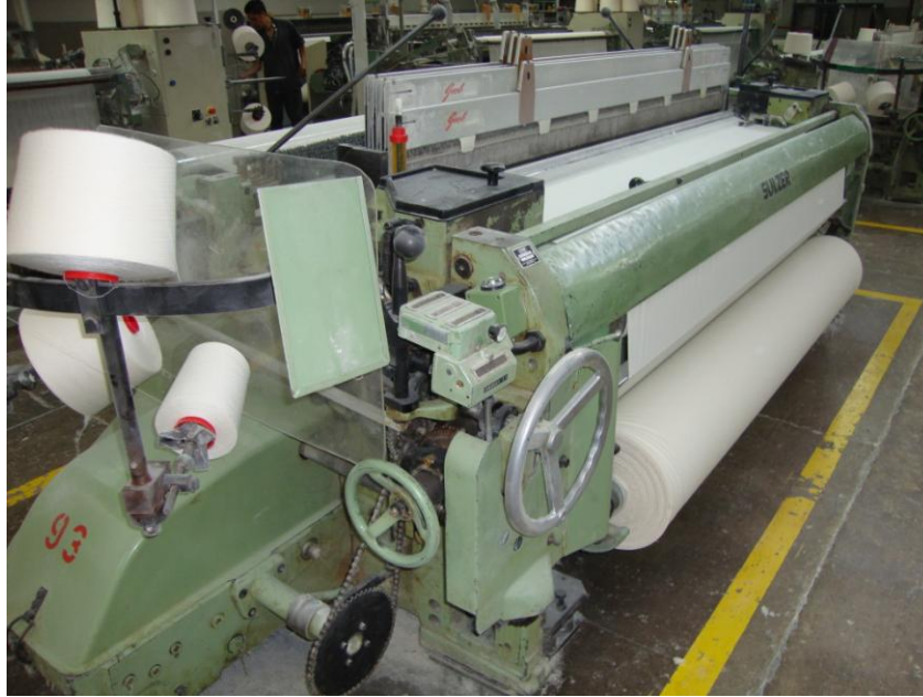
Telar marca Sulzer con sistema de inserción por proyectil
