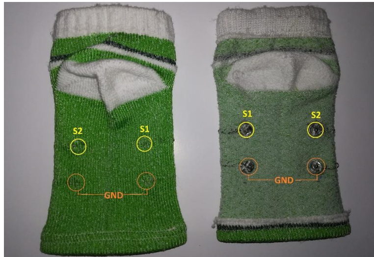
Figura 61. Ubicación de los broches para los sensores en la rodillera
