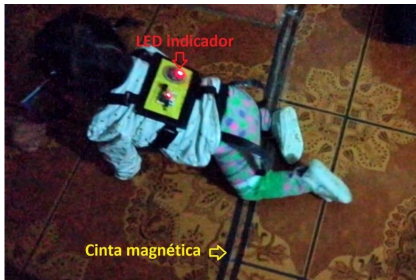
Figura 70. Prueba de envío de alarmas generadas por la cinta magnética
