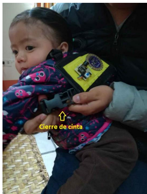
Figura 78. Ubicación y colocación de los cierres de cinta
