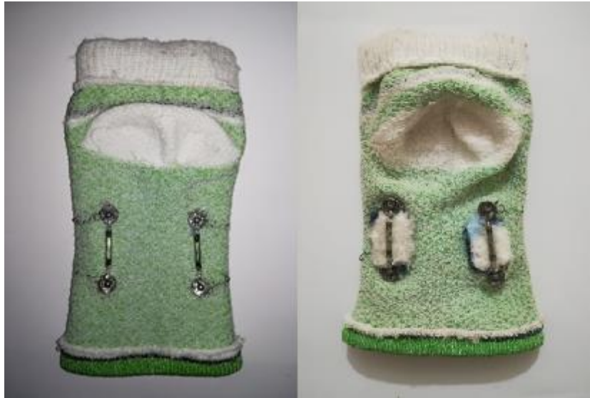
Figura 63. Sensores instalados en la rodillera de gateo
