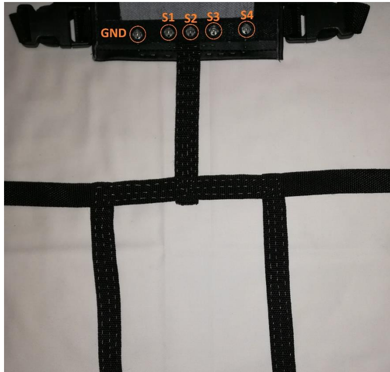
Figura 58. Extensión de las conexiones sobre cinta mediante hilo conductor
