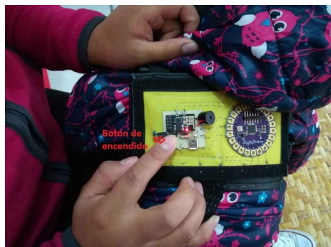
Figura 83. Inicio del sistema mediante el botón de encendido
