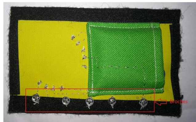
Fig. 16. Broches para la conexión de sensores y GND en el segmento desmontable Fuente: Elaborado por el Autor
