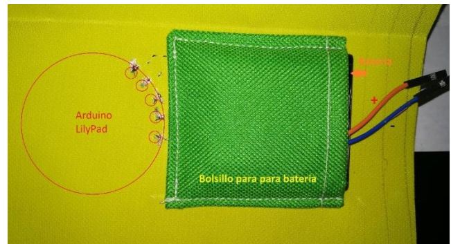
Fig. 15. Ubicación del bolsillo de la batería en la parte trasera del segmento desmontable Fuente: Elaborado por el Autor
