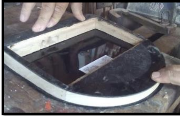
Figura 39 Dando el acabado de plástico al armazón de madera
