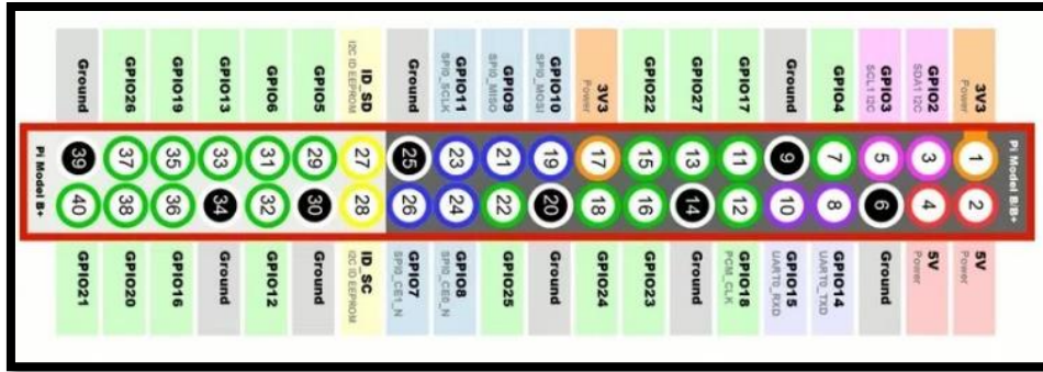
Figura 44 Numeración física de los pines GPIO
