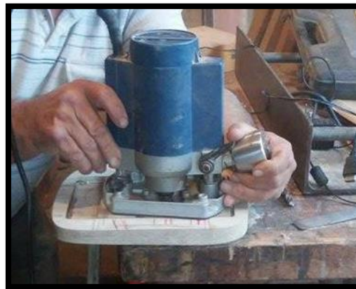
Figura 38 Corte de profundidad del módulo
