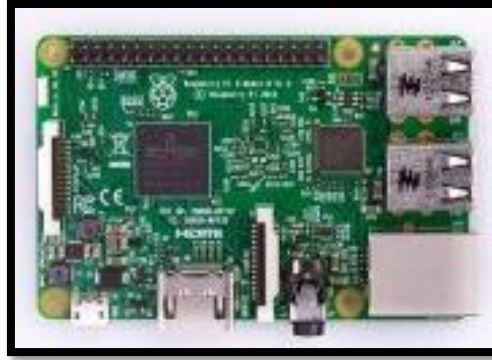
Figura 15 Raspberry Pi 3 Modelo B
