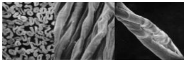
Figura 2: Fibra de algodón vista al microscopio
