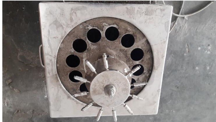
Figura 49. Soporte de muestras (tubos) antes de la reconstrucción.
