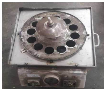
Figura 46. Eje central del equipo (vista exterior) antes de reconstrucción.
