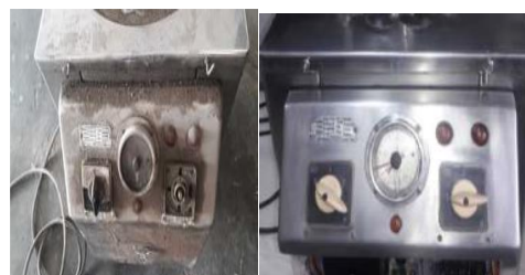
Figuras 4 y 5: Panel de control antes (izquierda) y después (derecha)
