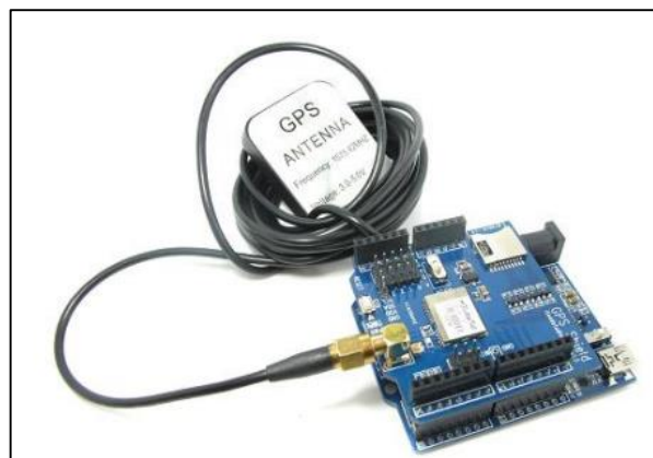
Figura 18. Módulo GPS NEO-6M-0-001. Fuente: (ITead Studio, 2011)
