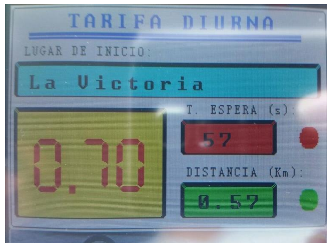
Figura 64. Funcionamiento en la tarifa diurna. Fuente: (Morales)
