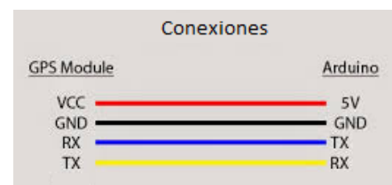
Figura 3. Conexiones módulo GPS con Arduino.
