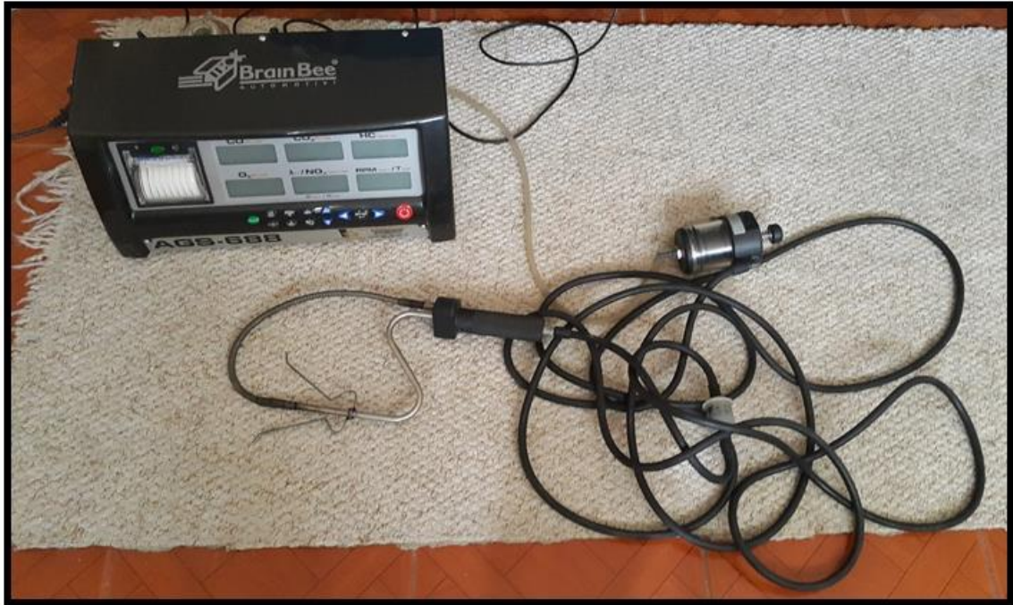
Figura 61. Equipo analizador de gases con su respectiva sonda, pre-filtro y trampa de agua.
