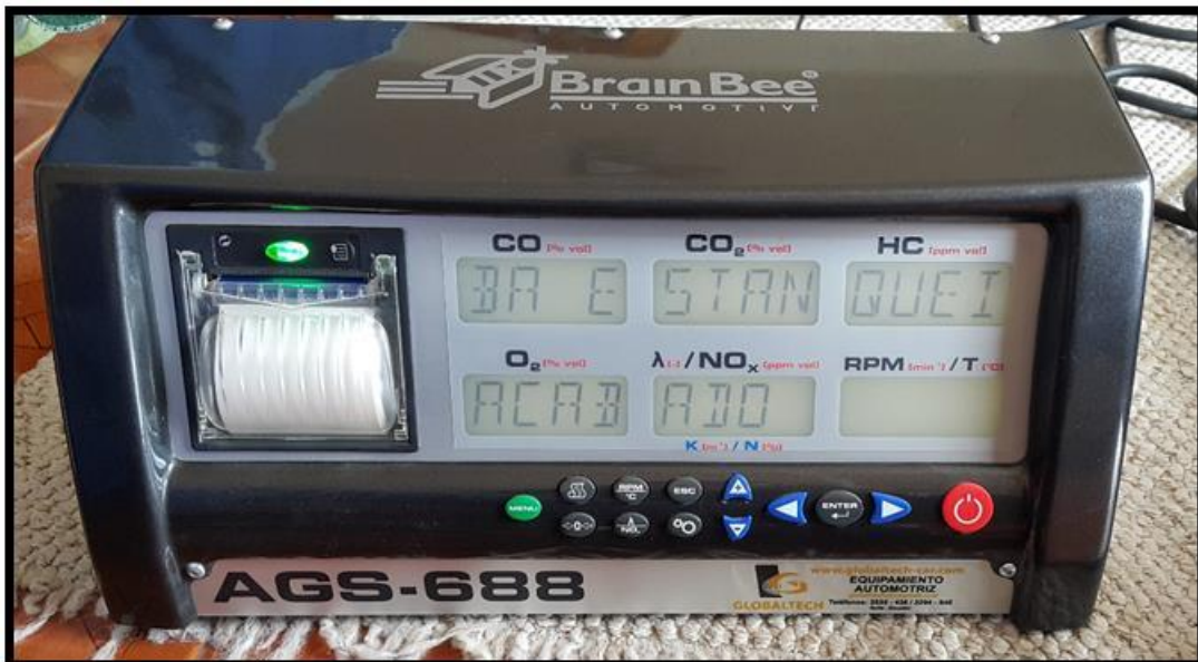
Figura 60. Finalización de la prueba de estanqueidad.
