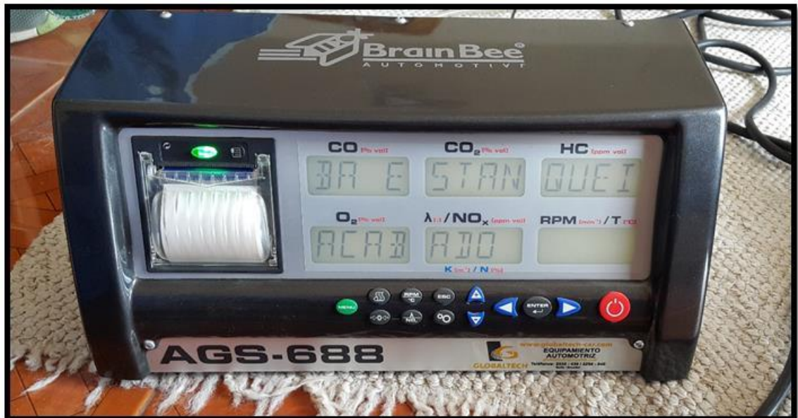
Figura 62. Prueba de estanqueidad realizada por el analizador de gases.
