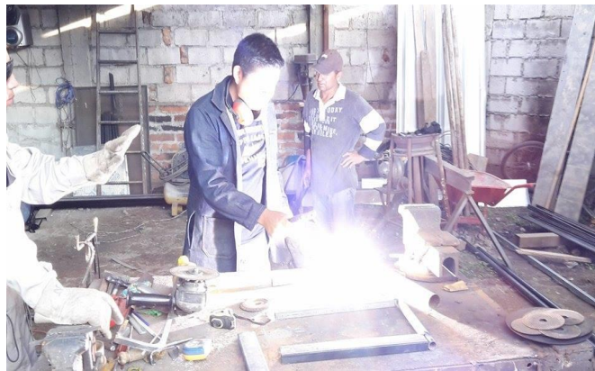
FIGURA 26: Unión de las partes del chasis mediante soldadura MIG
