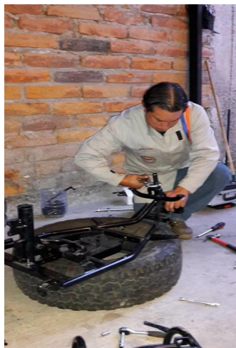
FIGURA 27: Ensamblaje de la dirección al chasis
