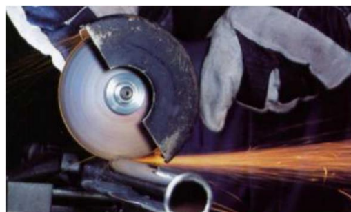
FIGURA 23: Corte manual de perfiles de acero
