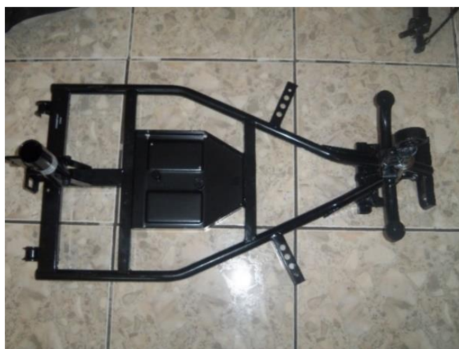
FIGURA 5: Esquema de chasis de hierro soldado
