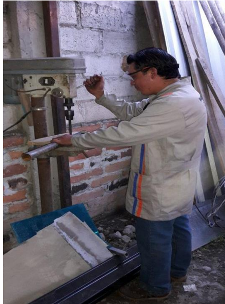
FIGURA 24: Taladrado de varias partes del chasis.
