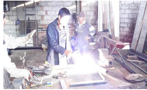
FIGURA 26: Unión de las partes del chasis mediante soldadura MIG
