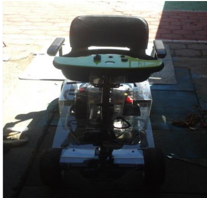
FIGURA 28: Silla de Rueda Motorizada Construida
