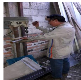
FIGURA 24: Taladrado de varias partes del chasis.
