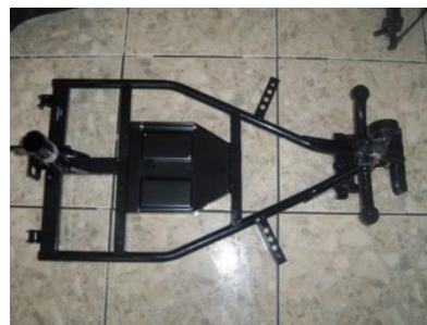
FIGURA 5: Esquema de chasis de hierro soldado
