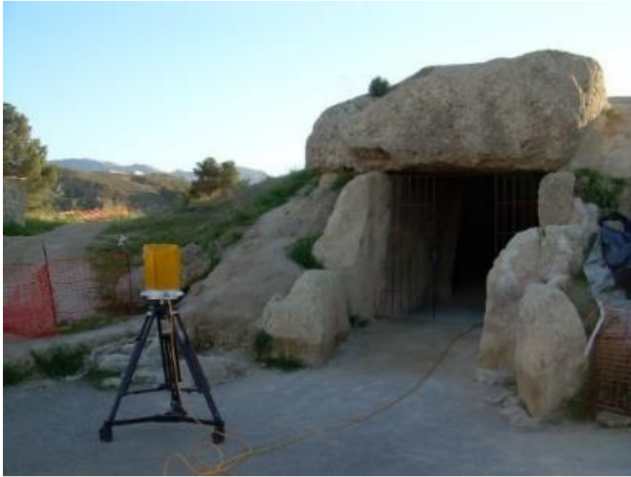
FIGURA 5: Escáner tipo tiempo de vuelo
