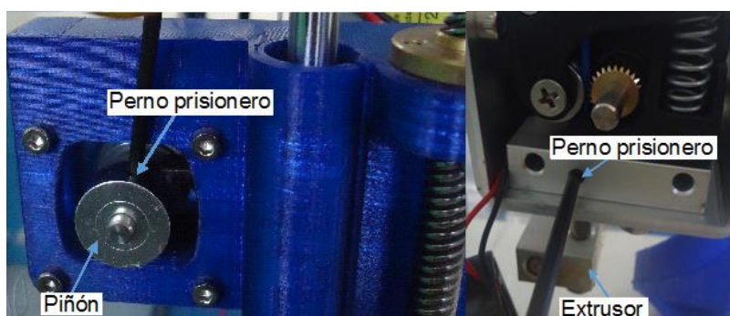
FIGURA 31: Ajuste de pernos prisioneros de las poleas y boquilla de extrusión
