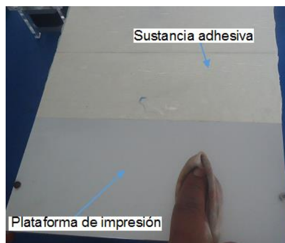
FIGURA 37: Remoción de material adhesivo de la plataforma de aluminio
