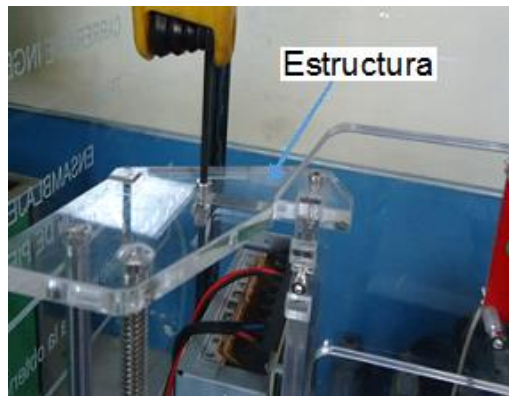
FIGURA 29: Ajuste de los pernos de la estructura
