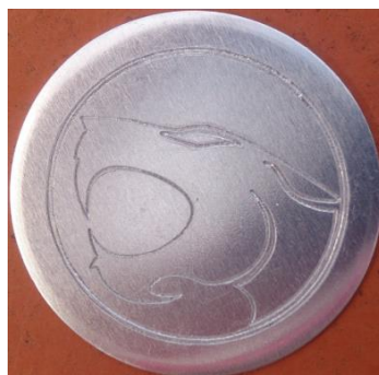
Figura 4-27. Prueba de grabado en placa metálica
