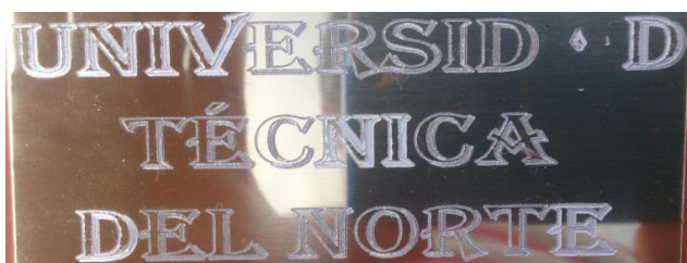
Figura 4-26. Prueba de grabado en placa metálica
