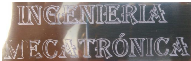
Figura 4-25. Prueba de grabado en placa metálica
