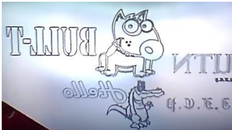
Figura 4-24. Prueba de grabado completo sobre placa de aluminio
