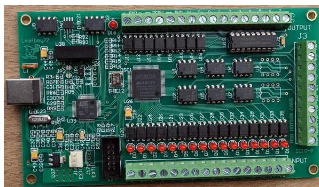
Figura 1-37. Tarjeta de control CNC utilizada
