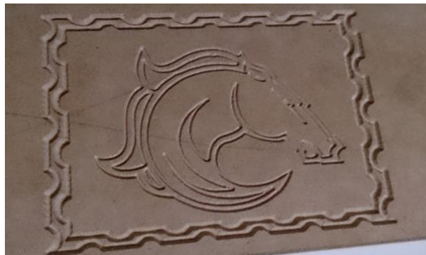
Figura 4-18. Prueba de grabado en madera
