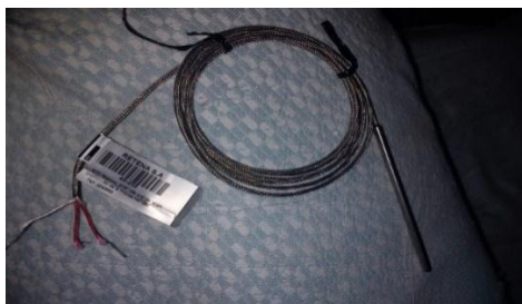
Figura 3. 64: Sensor Pt100 tres hilos.
