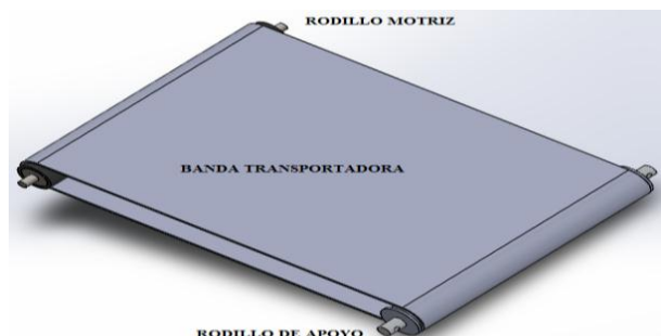
Figura 3. 4: Rodillo motriz y rodillo de apoyo.
