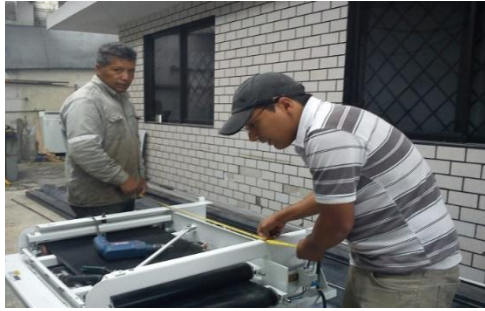
Figura 4. 6: Cámara de fusión.
