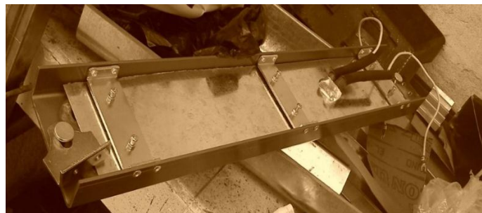
Figura 3. 63: Módulo de resistencias calefactoras.
