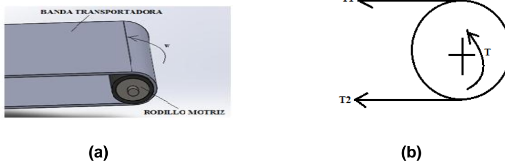
Figura 3. 20: a) Tensión de la cinta a cada lado, b) Diagrama de cuerpo libre.
