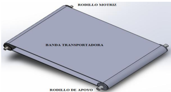
Figura 10: Rodillo motriz y rodillo de apoyo.
