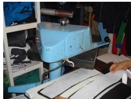
Figura 4: Proceso de fusonamiento con la estampadora.
