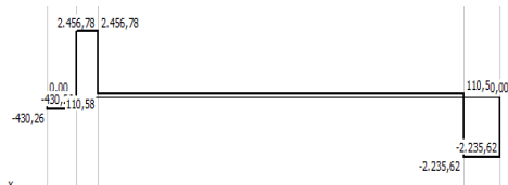
Figura 25: Diagrama de fuerza cortante plano X-Z- Eje del rodillo motriz.
