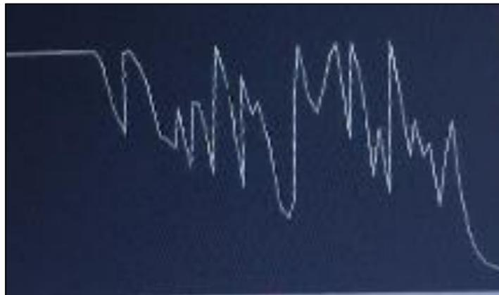
**Figura 4.16 Registros de EMG capturadas con la interfaz en LabVIEW ante una contracción sostenida.**
