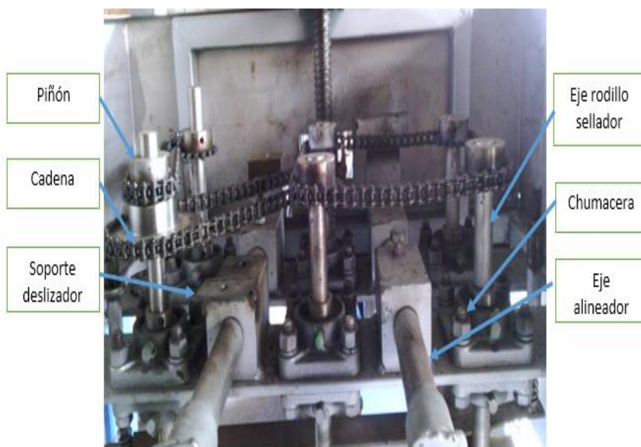
FIGURA 5.9: Implementación del sistema de transmisión
