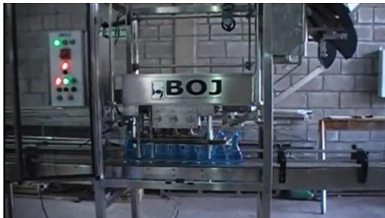
FIGURA 2.3: Máquina tapadora automática (BOJ, 2014)
