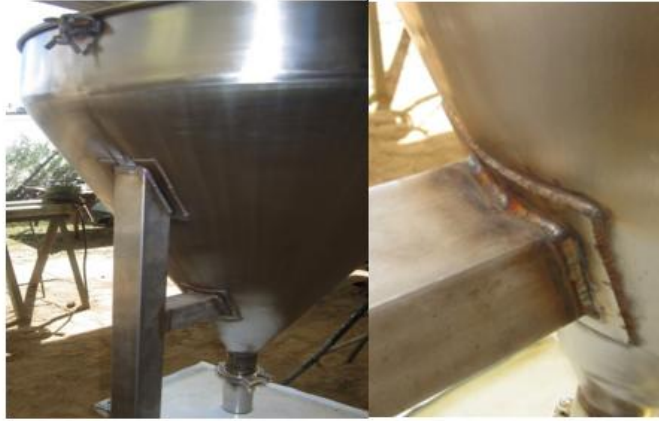
Figura VI.1 Montaje de la tolva en la estructura
