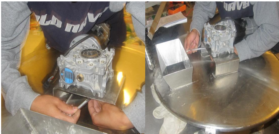
Figura VI.2 Montar el sistema motriz reductor-servo motor a la tapa de la tolva
