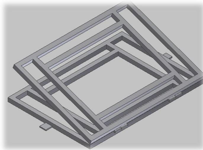
**Figura 22.** Bastidor para láminas. Fuente: Autor (Esteban Brusil A.).
