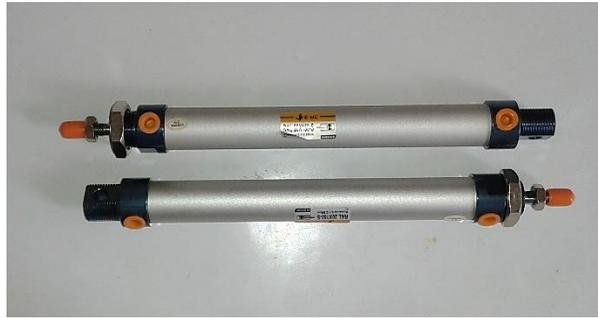
**Figura 66.** Cilindros RAL 20x150-S EMC. Fuente: Autor (Esteban Brusil A.).
