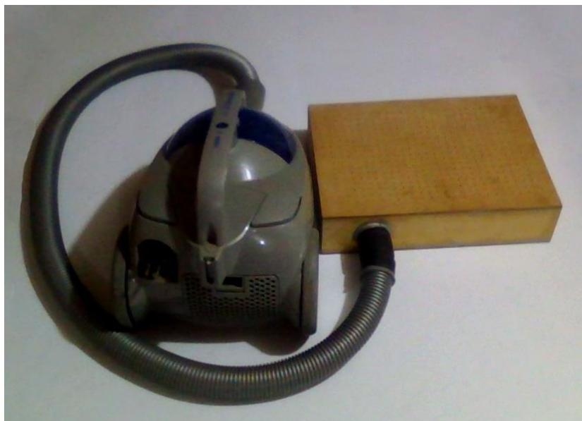
**Figura 27.** Aspiradora y cámara de vacío para pruebas. Fuente: Autor (Esteban Brusil A.).
