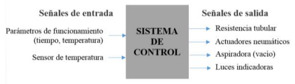
Figura 7. Diagrama de entradas y salidas del sistema de control.
