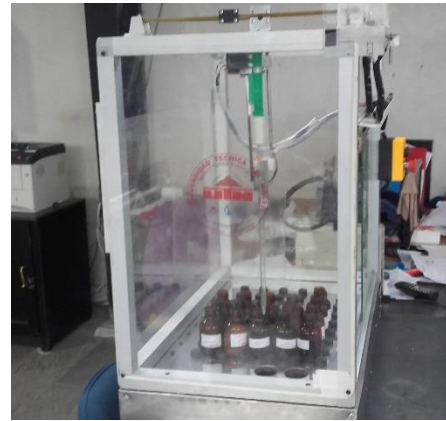
Figura. 2. Sistema de dosificación volumétrico implementado
