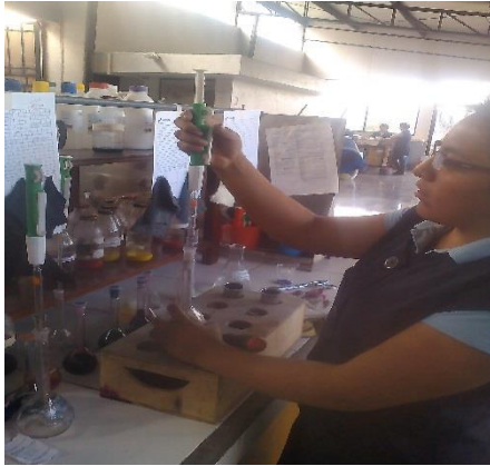
Figura. 1. Dosificación manual de colorantes líquidos. (Indutexma, 2016)
