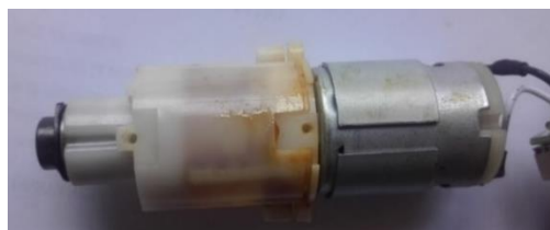
Figura 4.5 Motor DC con caja reductora.
