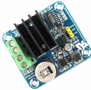
Figura 4.26 Módulo puente H
