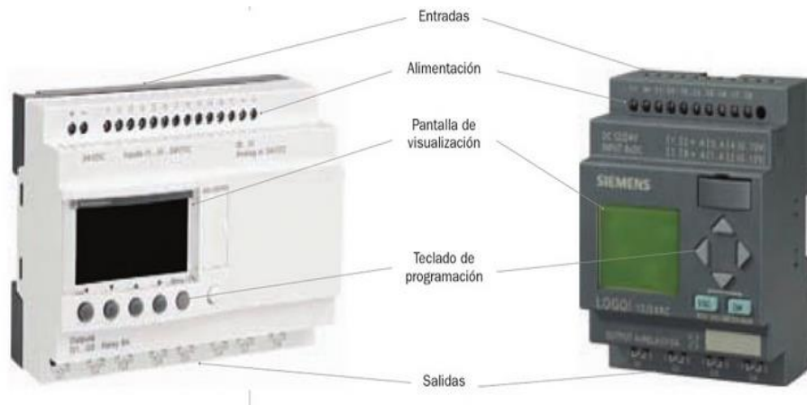
Figura 26 Partes de los relés programables ZELIO
