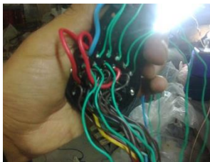
Figura 12 Ensamblaje de terminales para la comunicación entre PLC y las levas de trabajo
