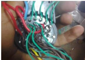
Figura 7 Terminal de levas buscando daño
