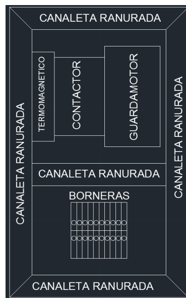
Figura 3.10 Distribución gabinete metálico.
