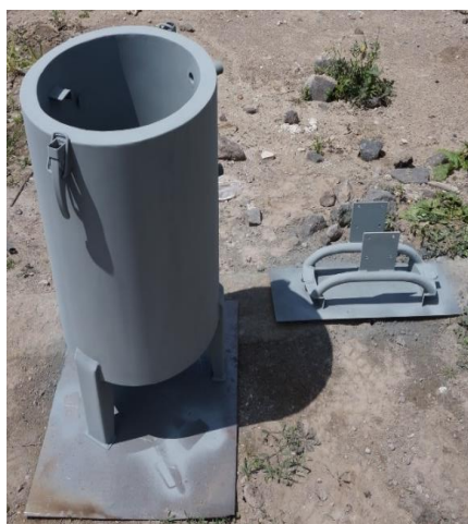
Figura 4.7 Recipiente contenedor de mezcla endotérmica luego de tratamiento contra la corrosión.
