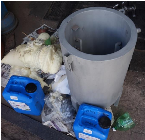
Figura 4.6 Recipiente contenedor de mezcla endotérmica inyectado poliuretano.
