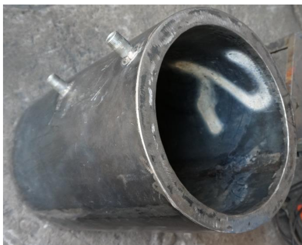
Figura 4.5 Recipiente contenedor de mezcla endotérmica.
