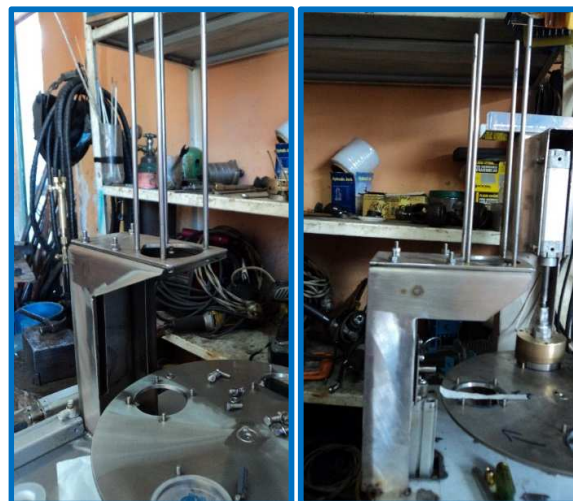
Figura 64: Vista de la estructura de soporte de las láminas de aluminio
