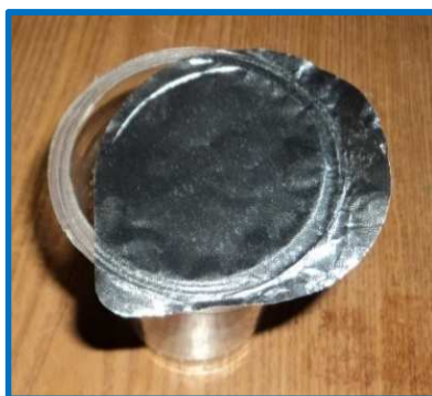
Figura 73: Lámina de aluminio descentrada
