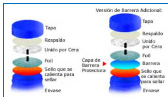
Figura 8: Un sello de 2 piezas unidas por cera, frecuentemente utilizado para aquellos productos volátiles o agresivos.
