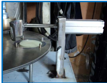
Figura 68: Vista lateral del soporte del brazo de expulsión
