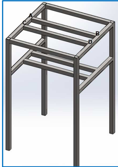
Figura 46: Estructura de la máquina selladora de vasos
