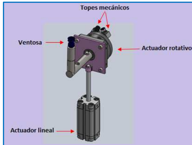
Figura 13: Mecanismo de movimiento con el actuador neumático rotativo
