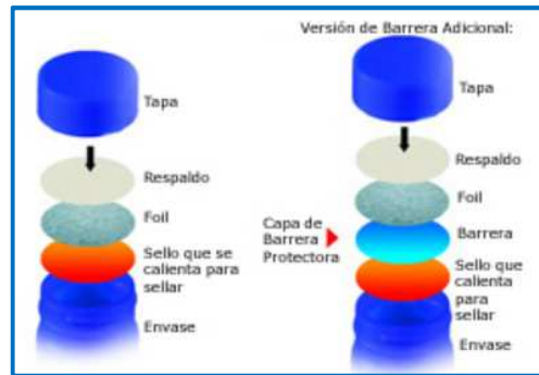
Figura 7: Sellos de una sola pieza, frecuentemente utilizados en la industria alimenticia y en bebidas.
