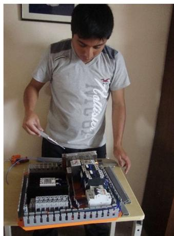
**Figura 4.10:** Instalación e inspección de la tarjeta de control
