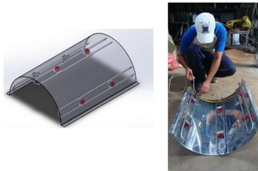
**Figura 4.2: Ubicación y colocación de las resistencias eléctricas**
