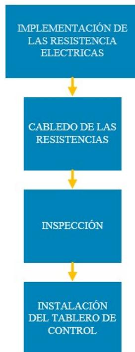
**Figura 4.1: Diagrama del proceso de implementación del sistema de calentamiento**
