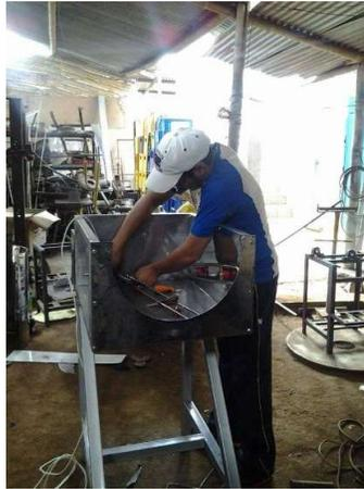
**Figura 4.3: Instalación de las resistencias eléctricas en el bastidor de la máquina**
