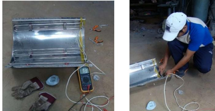
**Figura 4. 5: Cableado de las resistencias eléctricas**
