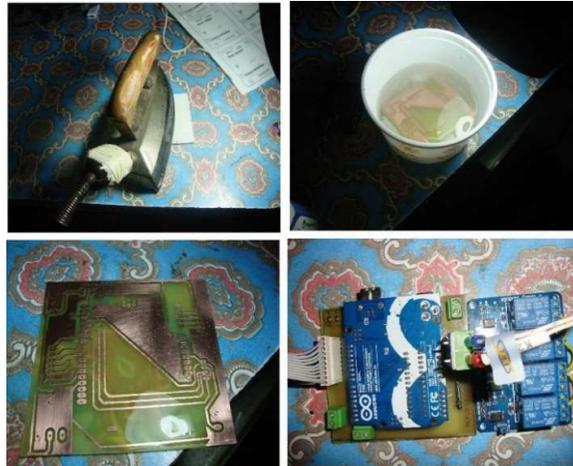
**Figura 4.9:** Fabricación de la tarjeta de control
