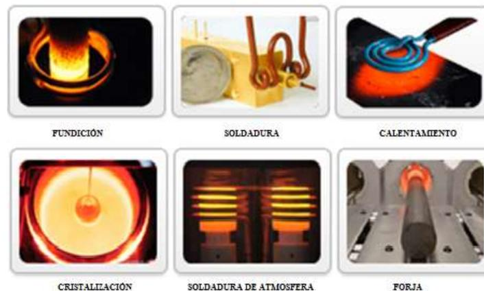
**Figura 1. 23: Aplicaciones del calentamiento por inducción**
