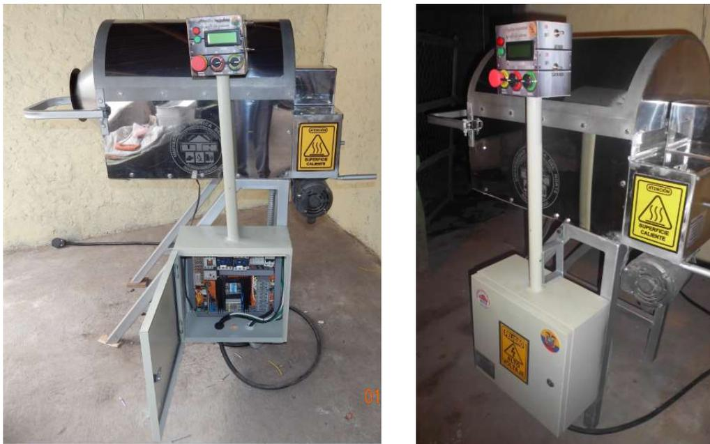
**Figura 4. 13: Instalación del conjunto gabinete - panel de control**
