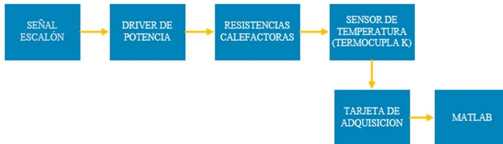
**Figura 3.5: Diagrama de flujo del sistema de adquisición de datos**
