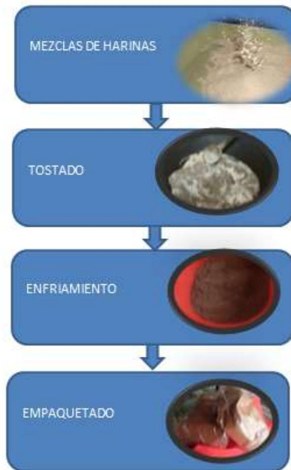
**Figura 1. 8:** Diagrama de flujo del proceso del café de quinua.
