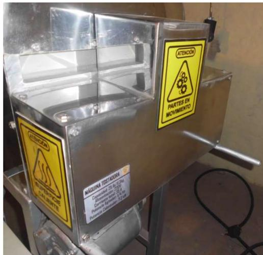
**Figura 3. 13:Montaje de la guarda de protección de poleas**
