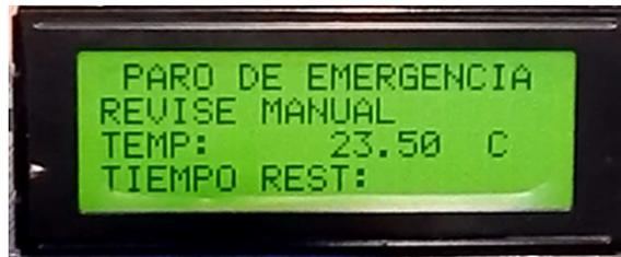
Si en caso de que el producto se encuentre dentro de la máquina retire inmediatamente como medida de seguridad para que el producto no se queme, y como sugerencia realice el proceso de tostado con el modo MANUAL de la máquina.
