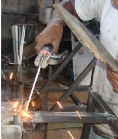
**Figura 3.10: Soldadura del bastidor**
