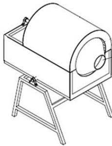
Figura 2: Máquina tostadora rotatoria por tandadas
