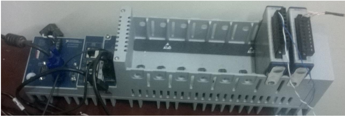
Anexos 3. Compact DAQ + Módulos de Voltaje y Temperatura
