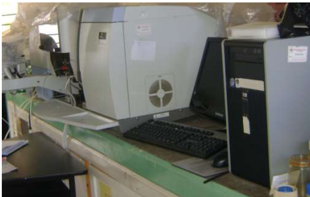
Fotografía 9.3: Equipo (Espectrofotómetro de absorción atómica) para determinación de minerales en el néctar de uvilla.
