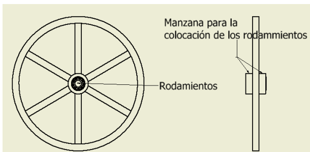
Figura 31.- El volante de arrastre y sus elementos.
