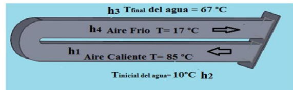
Figura 35.- Entalpías en la transferencia de calor del intercambiador al agua de la tina de escaldado.
