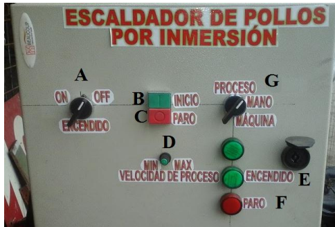
Figura 43. Elementos externos para el control de la máquina.
