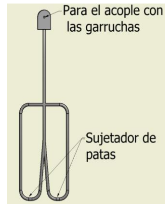
Figura 23.- Dispositivo de sujeción para el transporte de los pollos Fuente: (INDUMETAVI, 2015)
