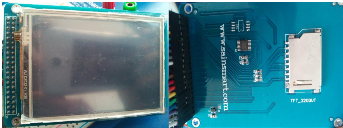
Figura 13. Pantalla TFT_320QVT - LCD de 3.2"
