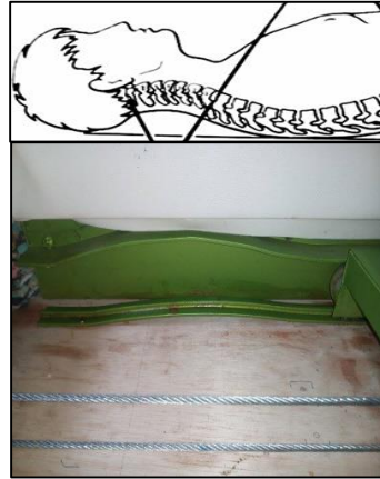
Figura 18. Deformación de los rieles.
