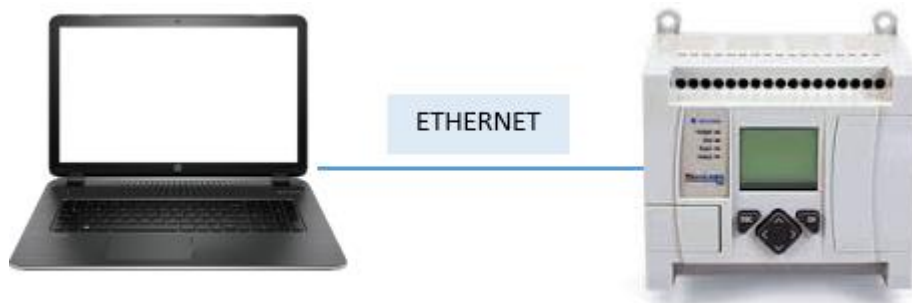
Figura 12. Interfaz con RJ 45 PLC -Ordenador
