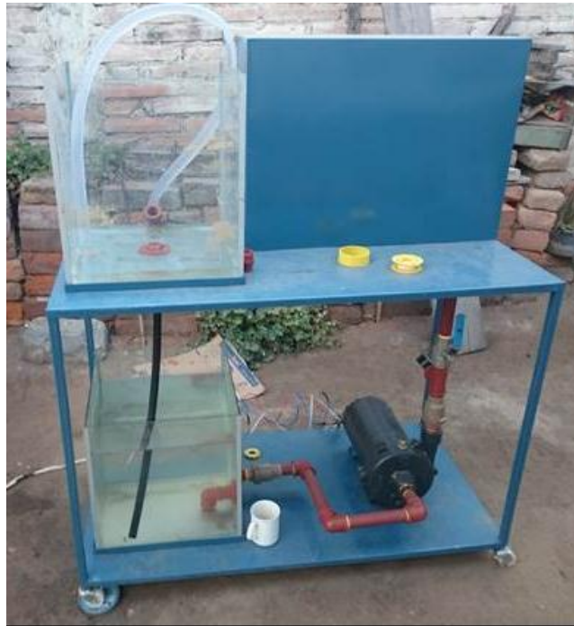
Figura 57 Colocación del tanque principal, taque de reserva y la electrobomba
