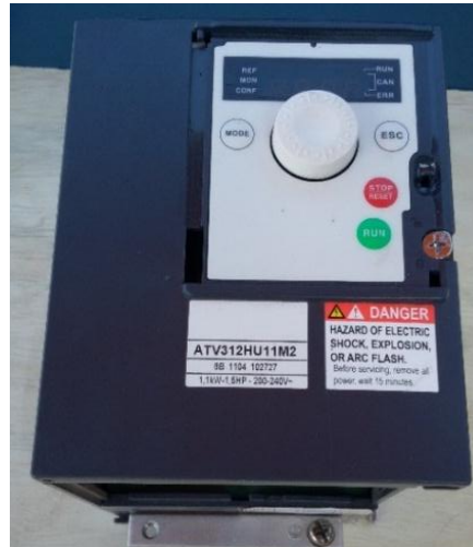
Figura 19 Variador de frecuencia
