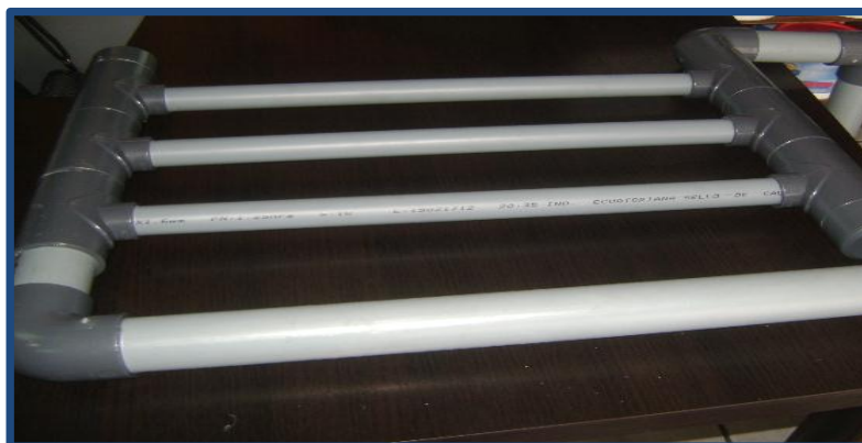
Figura N°. 37 Construcción de la tubería para el sistema de riego
