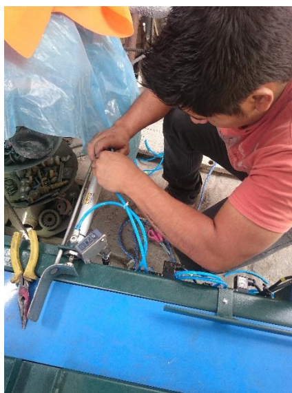
Ilustración 12: Alimentación de aire al cilindro
