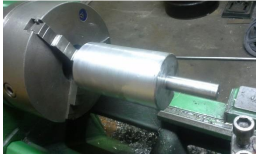
Ilustración 2: Diseño del rodillo con eje para el motor reductor
