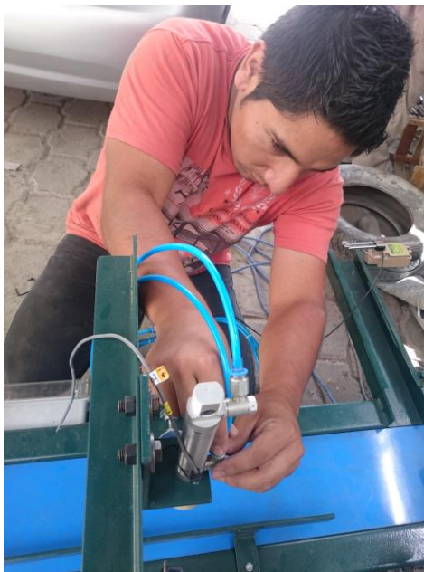
Ilustración 11: Alimentación de aire al cilindro
