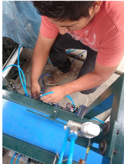
Ilustración 10: Alimentación conexión de electroválvula 5/2 monoestable
