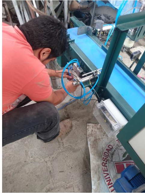
Ilustración 9: Alimentación conexión de electroválvula 5/2 monoestable
