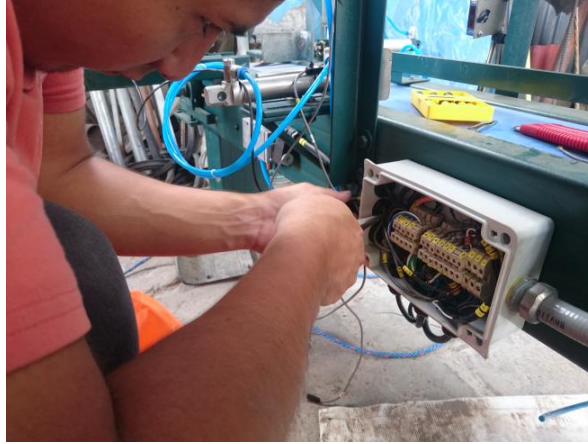
Ilustración 15: Conexión de sensores
