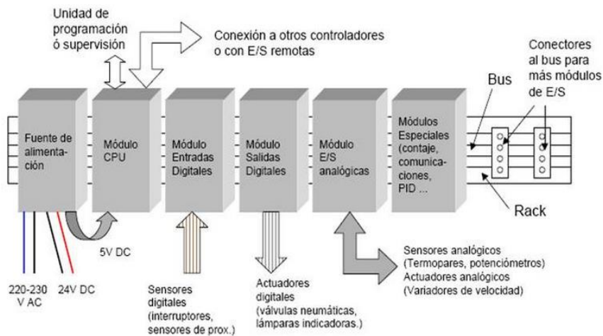
Gráfico 27: Arquitectura interna del PLC
