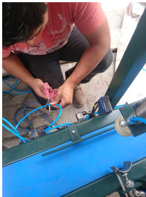
Ilustración 8: Corte y conexión de tubería
