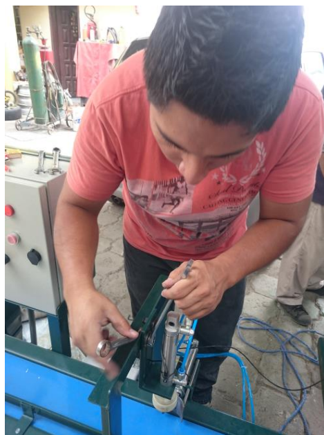
Ilustración 14: Ajuste de nivel del cilindro A
