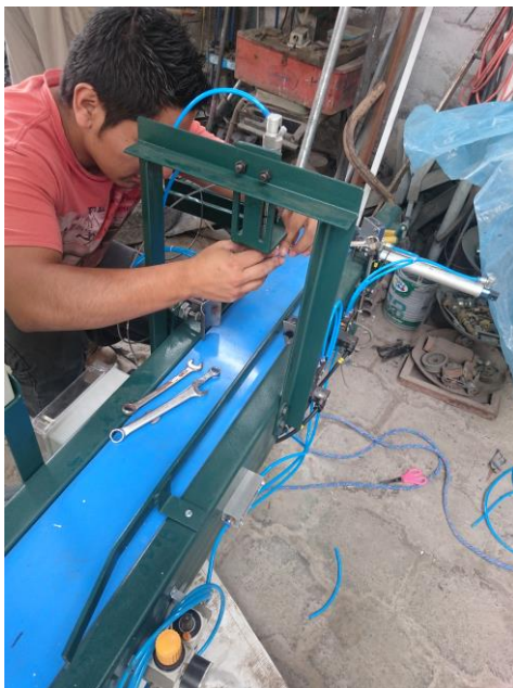
Ilustración 13: Ajuste del sellador de tapas
