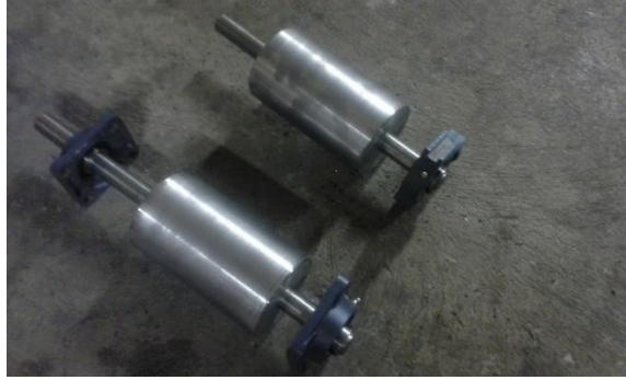
Ilustración 4: Verificación de ejes de rodillos para las chumaceras
