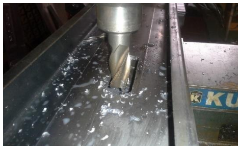
Ilustración 1: Perforación para ajustar la banda
