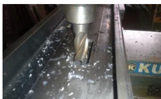
Ilustración 1: Perforación para ajustar la banda
