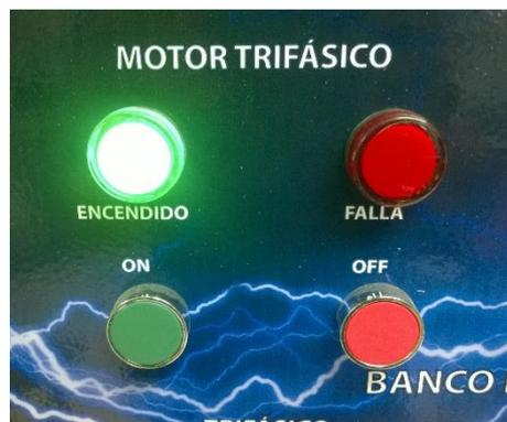
Figura 25. Pulsador de encendido y luz indicadora de motor trifásico en marcha.
