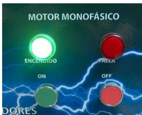
Figura 2. Pulsador de encendido y luz indicadora de motor monofásico
