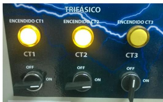
Figura 4. Encendido del segundo banco de condensadores
