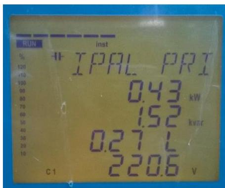
Figura 36. Parámetros de medida del motor monofásico
