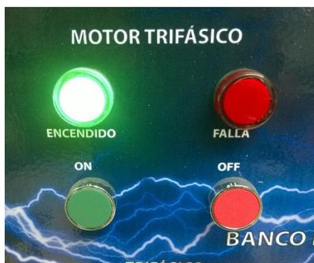
Figura 2. Pulsador de encendido y luz indicadora de motor trifásico en marcha.
