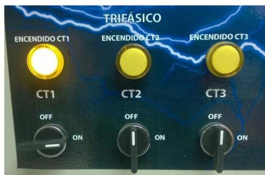
Figura 3. Encendido del Primer banco de condensadores
