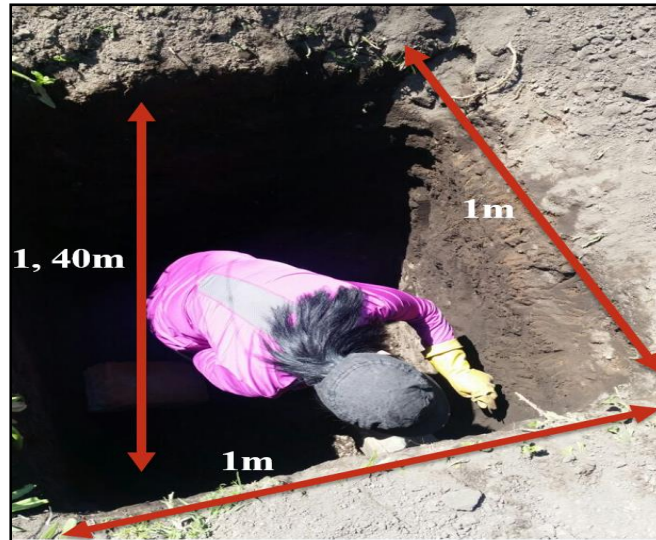
Figura 7. Dimensiones de la calicata.
