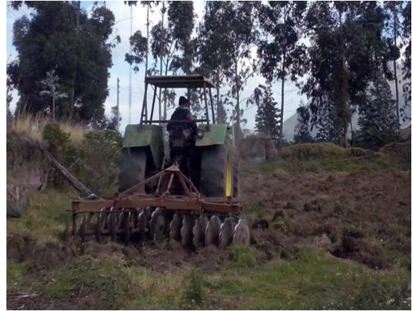
Fotografía 8. Limpia del terreno con pase de arado y rastra
